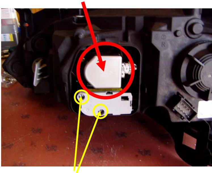
4. die beiden Torx-20 Schrauben vom Motor für die Leuchtweitenregulierung rausschrauben und den Motor herausnehmen
