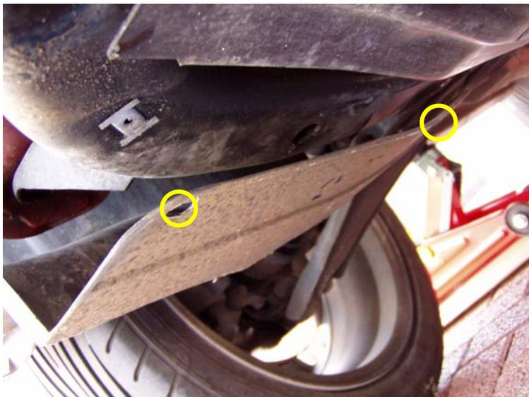
2 Schrauben (Torx-20) unten lösen
