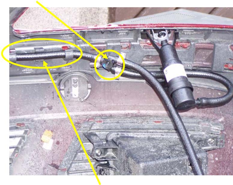
7. Schlauch in die Führung an der Stoßstange einhängen
