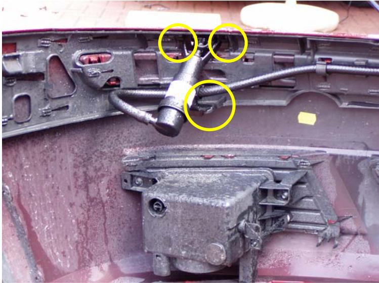
5. Schlauch auf Länge schneiden und an den beiden Spritzeinheiten befestigen, dabei Schlauchschellen nicht vergessen (Hochdruck!)
