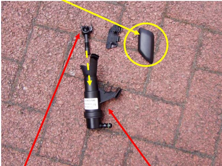
2. Düsen bis zum Anschlag in die Halterung stecken (dazu den Einsatz herausziehen, das macht sich gut mit einer 2. Person da eine sehr starke Feder verbaut ist)
